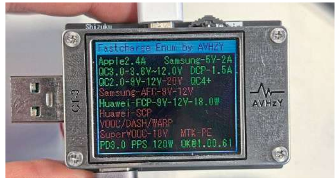
Con un módulo de prueba USB, comprobamos qué estándares de carga soportan las powerbanks y qué potencia en vatios admiten con Power Delivery.
