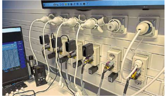
En el laboratorio se midió la corriente de carga con la que los powerbanks se recargan. En modelos de baja calidad, se pierde mucha energía en el proceso.
